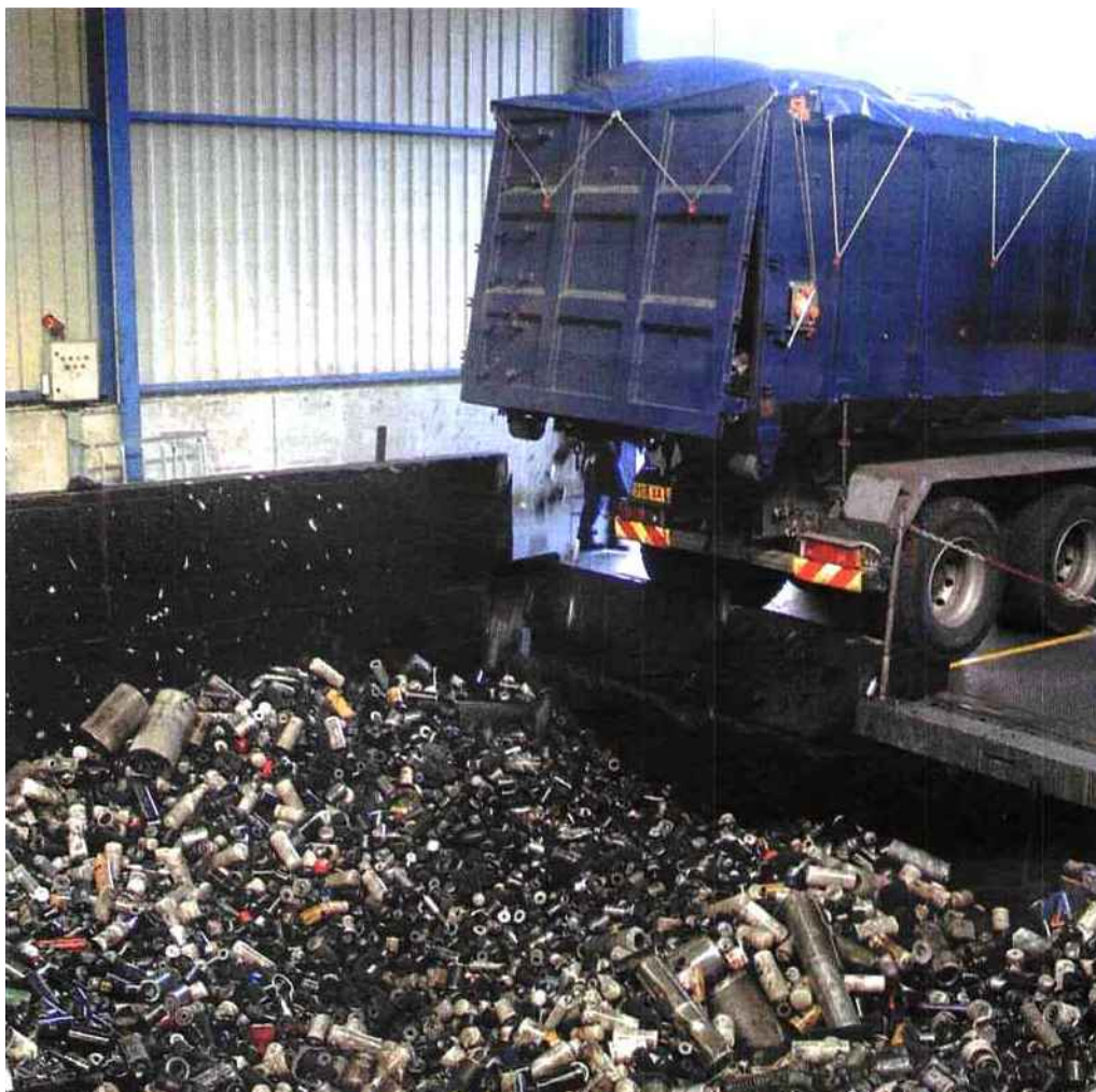
Collecte de filtres à huile. Sur les 700 grammes de chaque unité, seuls 10 ne sont pas recyclables.
